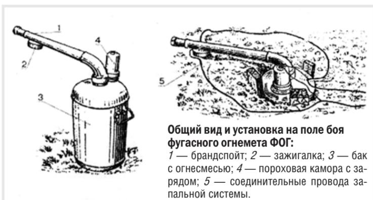
Общий вид и установка на поле боя фугасного огнемета ФОГ:
