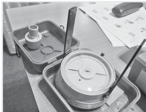
Буссоль. Геодезический инструмент для измерения углов при съемках на местности, специальный вид компаса
