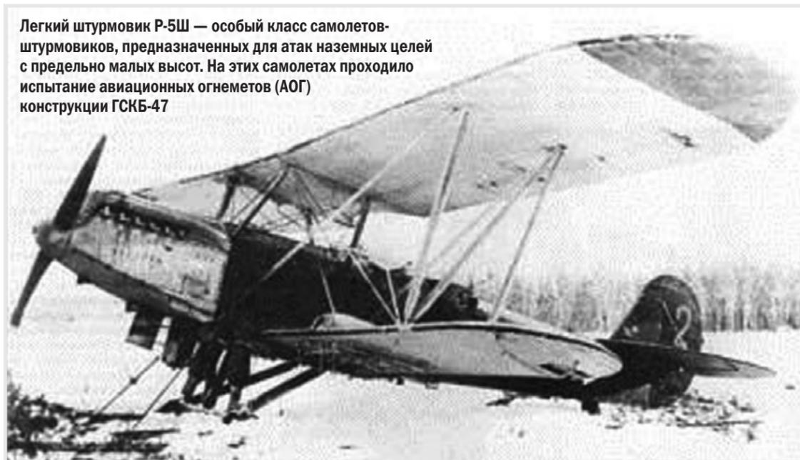
Легкий штурмовик Р-5Ш — особый класс самолетов-штурмовиков, предназначенных для атак наземных целей с предельно малых высот. На этих самолетах проходило испытание авиационных огнеметов (АОГ) конструкции ГСКБ-47
